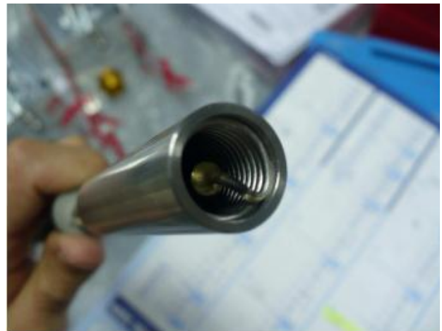
图3 高压气体循环池内部
